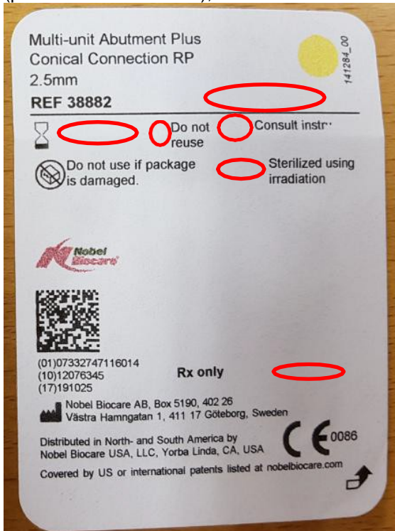
Afbeelding 1. De foto toont het onjuiste productetiket voor de Multi-unit abutment Plus CC RP 2,5 mm (productnummer 38882), lotnummer 12076345. De ontbrekende informatie is met rood gemarkeerd.
