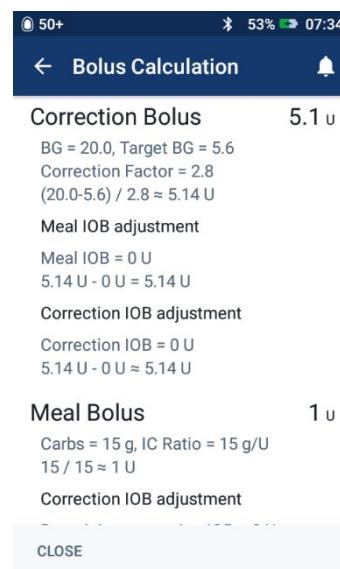
Afbeelding 8: Berekeningen weergeven incorrecte bolus hoeveelheid gebaseerd op een oude BG meting
