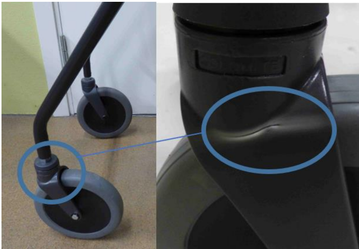
Fig 1: Duidelijk zichtbaar teken van beginnende scheuren op de linker voorvork. (Een wit uitgeslagen lijn over de vork)
