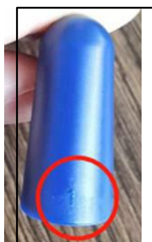
Figuur 1: Defect verwijderbaar L-verbindingstuk nummer 1
