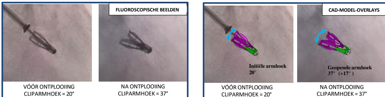
Afbeelding 1: Fluoroscopische beeldvorming van een clip die opengaat terwijl vergrendeld (COWL) tijdens ontplooiing (links) met CAD-model-overlay (rechts)
