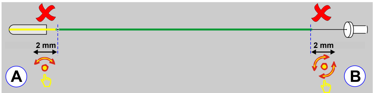
Afbeelding 3. Scenario's A en B waarin het gebruik van de functie Catheter Bending (Katheter buigen) kan leiden tot het ontstaan van een reconstructiefout.
