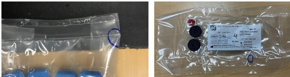
Afbeelding 1: Foto's van pinhole-lekken in de steriele barrière (omcirkeld met marker)
